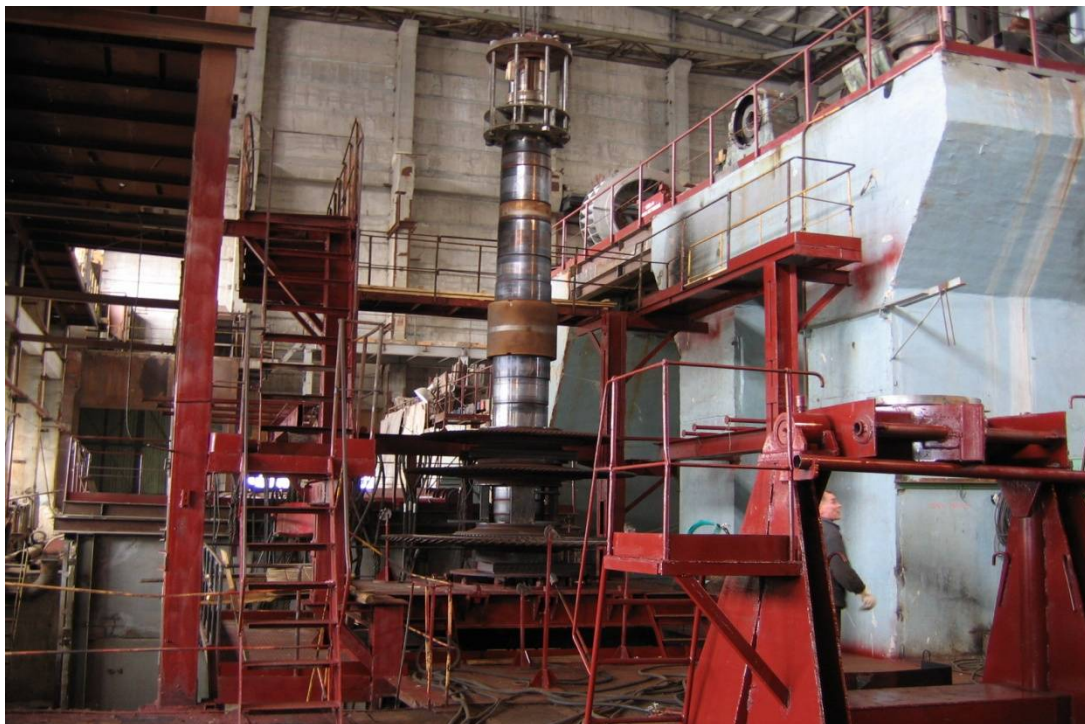
Рис.3. Стенд для вертикальной разборки-сборки роторов
