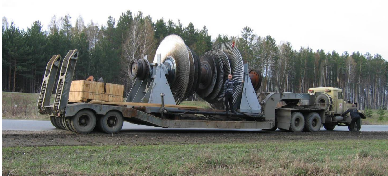
Рис.6. Транспортировка реконструированного РНД в специализированной кассете для перевозки роторов
